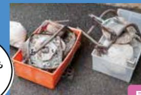
焼却炉の中から出てきた、2cmより大きな金属などを灰の中から取り除きます。
