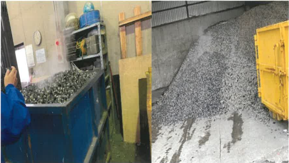
(コンビニの袋やナイロン系は熱を加えチップ化し、パルプ工場の燃料として再利用される)
