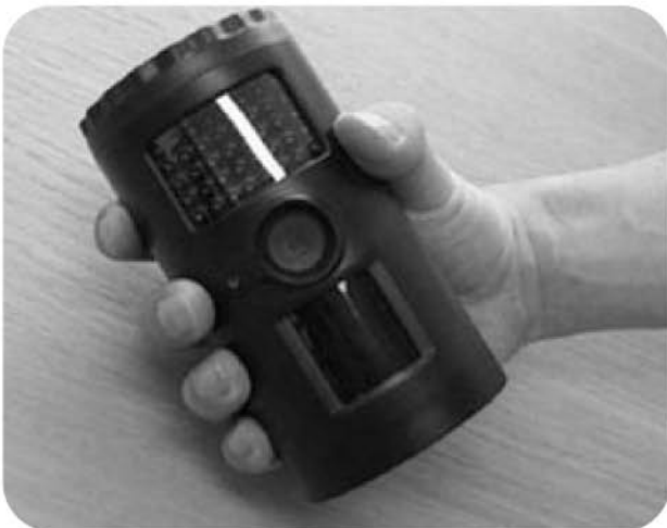
有害鳥獣の夜間撮影用カメラ (モデル地区に設置予定)
